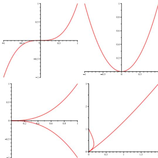
Figure: Inflexion ( $t, t^3$ ) ; cas standard ( $t, t^2$ ) ; rebroussement première espèce ( $t^2, t^5$ ) ; rebroussement seconde espèce ( $t^2, t^2 + 2t^4$ )
